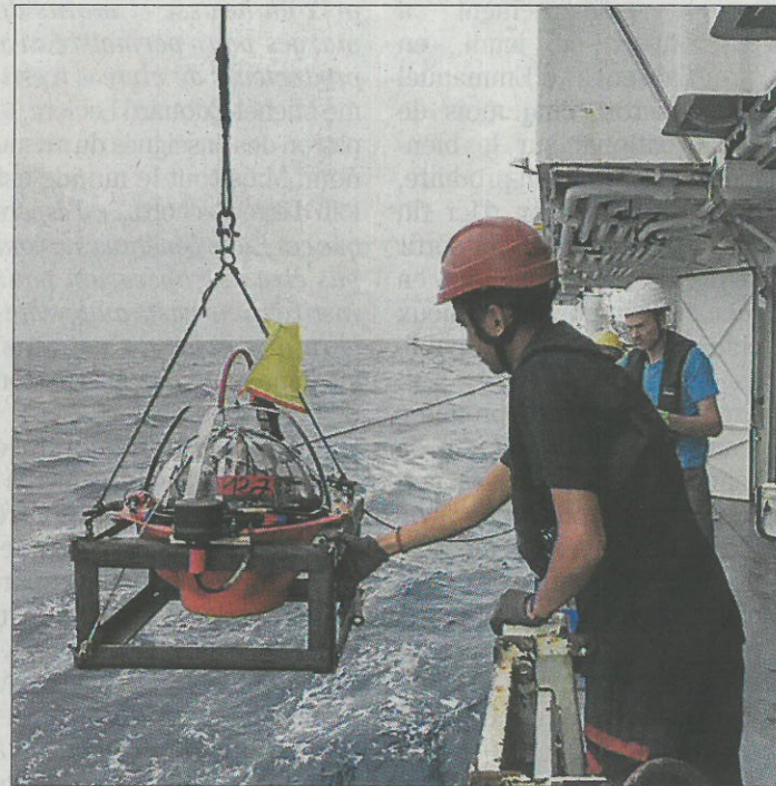
■ Largage d'un sismomètre au fond de la mer. ANNE DELPLANQUE
